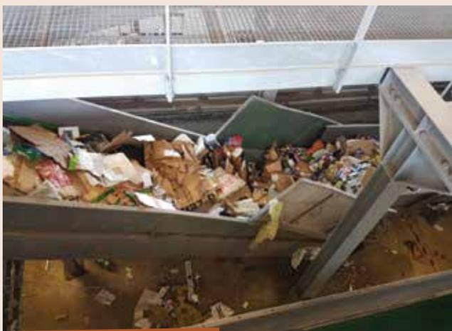
cartons en sortie du crible rotatif
